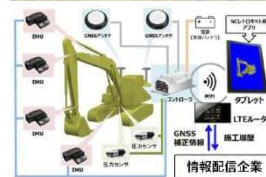
ICT機器を後付けした建設機械とGNSS・自動追尾型トータルステーションの併用によるICT施工
