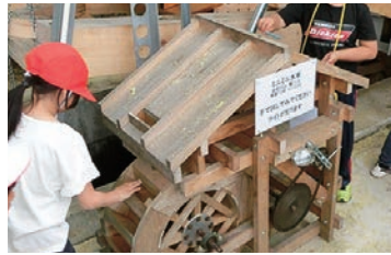
自分で回して発電できるミニミニ水車
