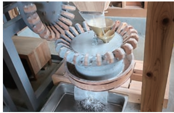
水車の回転力を利用した粉挽きの様子
