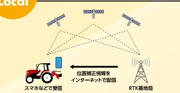
トラクターや田植機、ドローンなど農業機械の高精度な自動操縦を可能とするRTK基地局を県内7カ所に整備しています。
