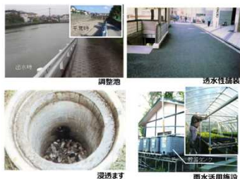
雨水貯留浸透施設の例
