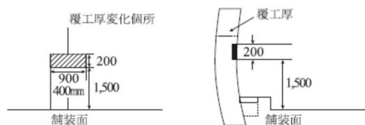
図6-1 覆工厚変化箇所の刻示標準図
