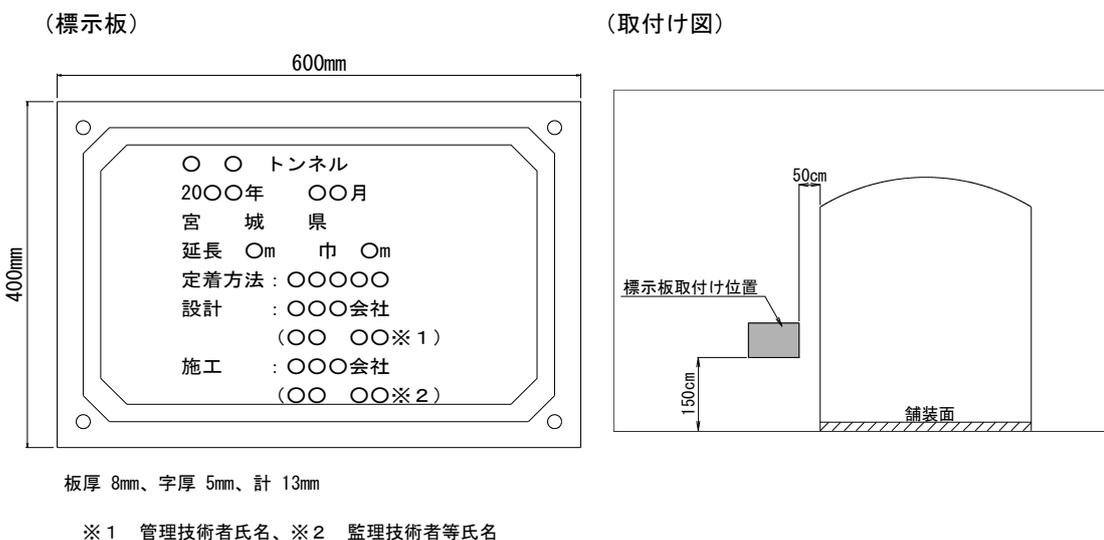
図6-2 標示板の設置イメージ図
