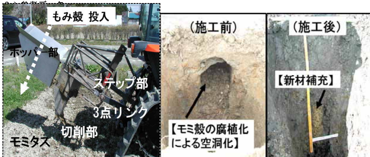
写真1 初殻簡易開削充填機[モミタス]の構成と施工効果
