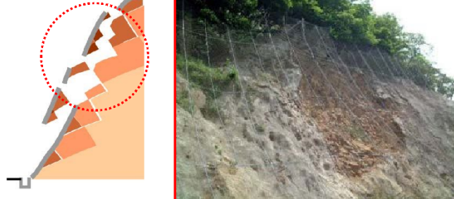
図 2.2.1(3) 吹付け法面の老朽化のメカニズム
