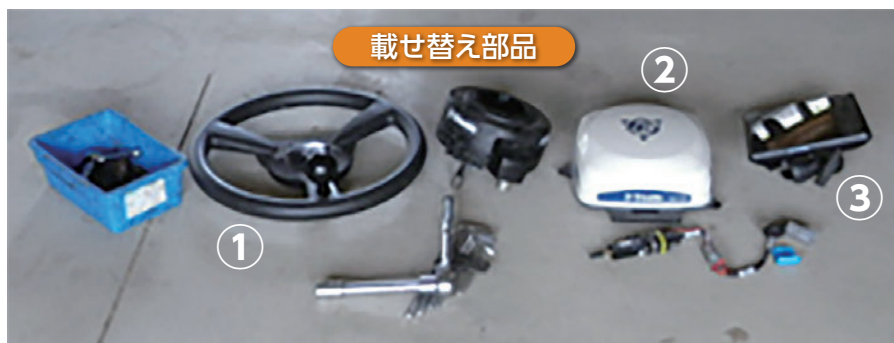
①ハンドル・オートパイロット ②アンテナ ③ガイダンスディスプレイ
