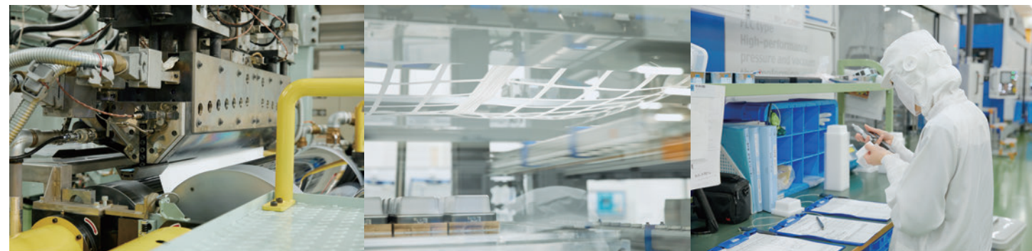
▲ 食品容器の製造過程：プラスチックシートの製造工程（左）、豆腐容器を切り抜いた残りの部分（中央）、検査工程（右）
