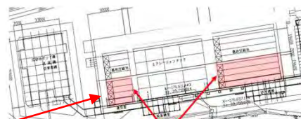
1系水処理施設 最初沈殿池・最終沈殿池
