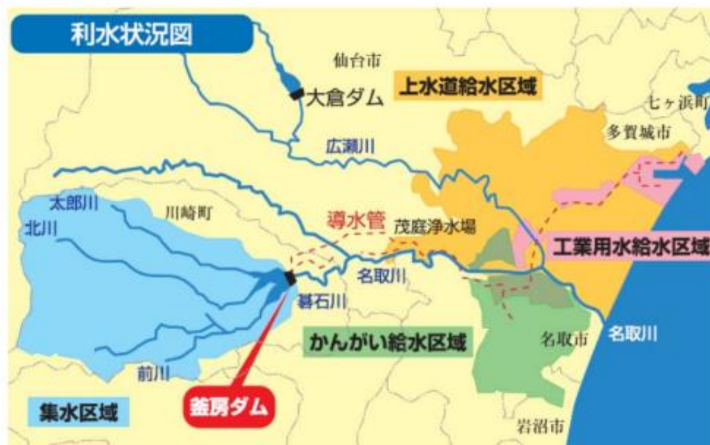
図 3.8-6 釜房ダムの利水状況図
