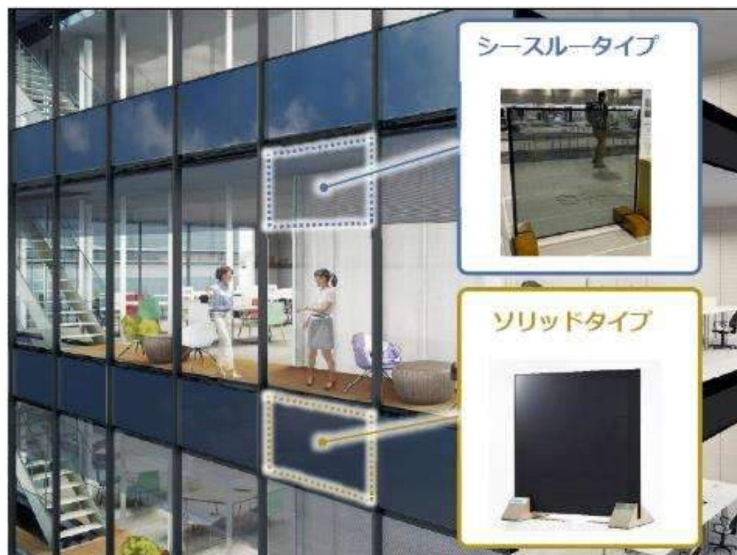
窓用・壁用のBIPVの導入イメージ
