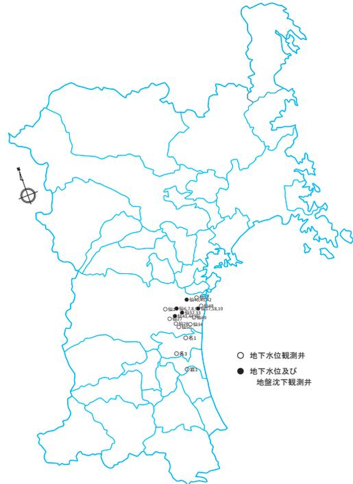
▲図2-4-1-24 地盤沈下観測井位置図
