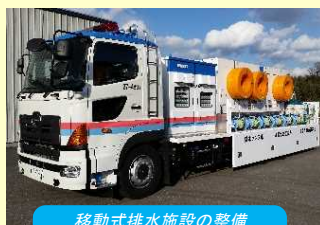
移動式排水施設の整備
