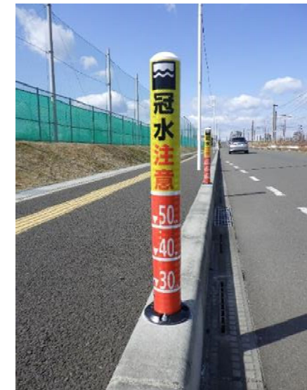
設置した水位標
