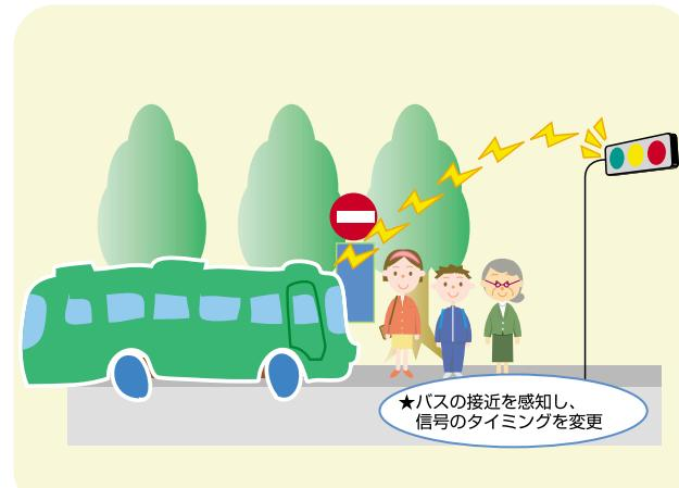
公共交通を便利にする方法の一つに、バスが走行しやすいよう車両の接近に合わせて信号をコントロールする公共交通優先システムがある。信号の待ち時間を減らして、所要時間の短縮を図るんだ。
