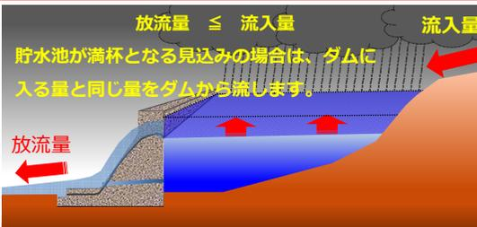
異常な大雨が降り、あらかじめ決められた洪水より多くの量の水がダムに流れ込んだ場合、ダムでは洪水を貯めつつ下流へ流す操作をいたしますが、貯水池が満杯となる見込みとなった場合には、**最大で流入量と同じ量を下流に放流することがあります。**このことを**異常洪水防災操作**といいます。
