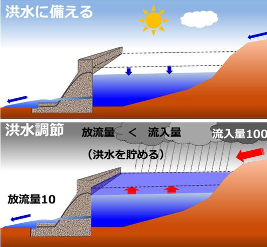
台風や大雨による洪水の起きやすい季節には、貯水水位を所定の水位まで下げて容量を確保しておき、洪水をダム貯水池に貯めるための準備をします。
