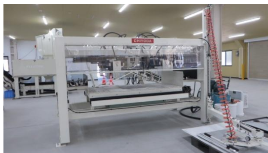
図 40：廃太陽光パネルの処理設備
