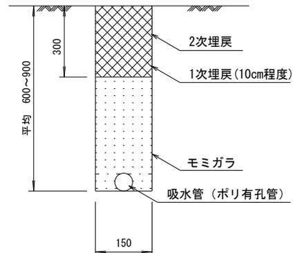
補助吸水渠断面図
