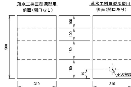
木製堰板設置後断面図
