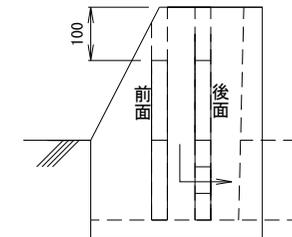
木製堰板設置後断面図
