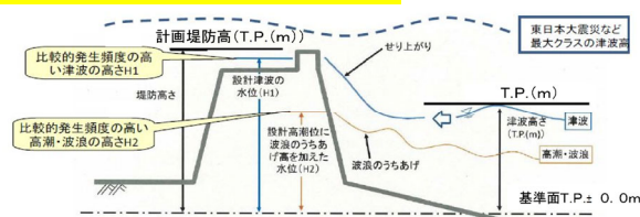
計画堤防高：設計津波水位と高潮・波浪の高さの低い方＋余裕高
