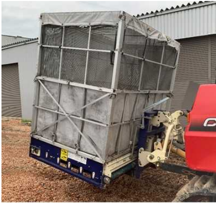
図8 もみ殻散布機の例 (K社製まい太郎)
