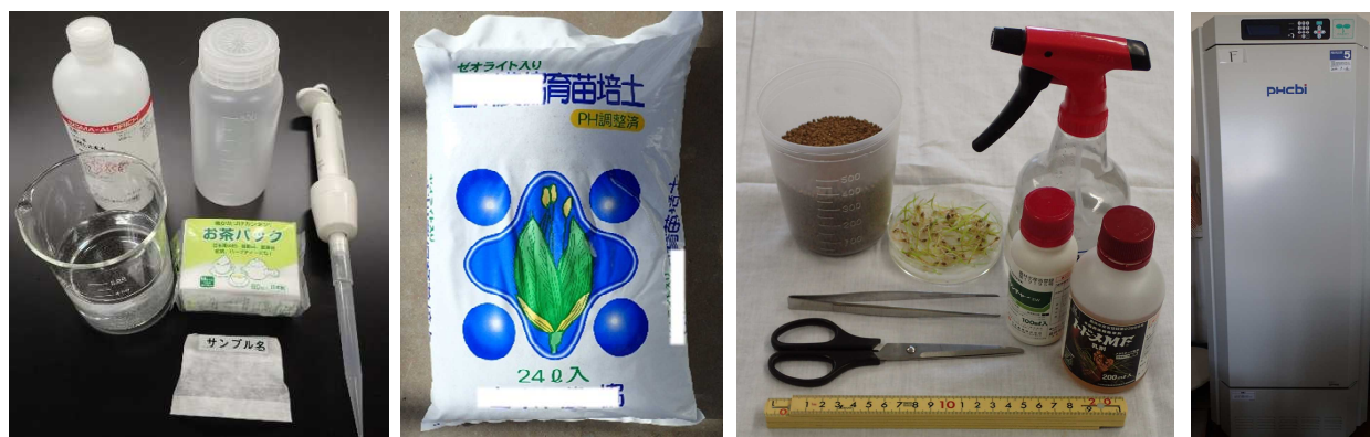
図 4 使用資材・器具（左から、①30%過酸化水素水、プラビン、ビーカー、蒸留水、不織布容器(お茶パック)、マイクロピペット、②育苗培土、③500mL プラポット、ノビエ苗、9 cm シャーレ、ろ紙、500mL ハンドスプレー、100mL クリンチャーEW、200mL トドメ MF 乳剤、ピンセット、はさみ、メジャー、④グロースチャンバー
