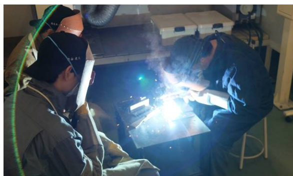
「現代の名工」から学ぶ機械科実習 被覆アーク溶接(黒川高校)
