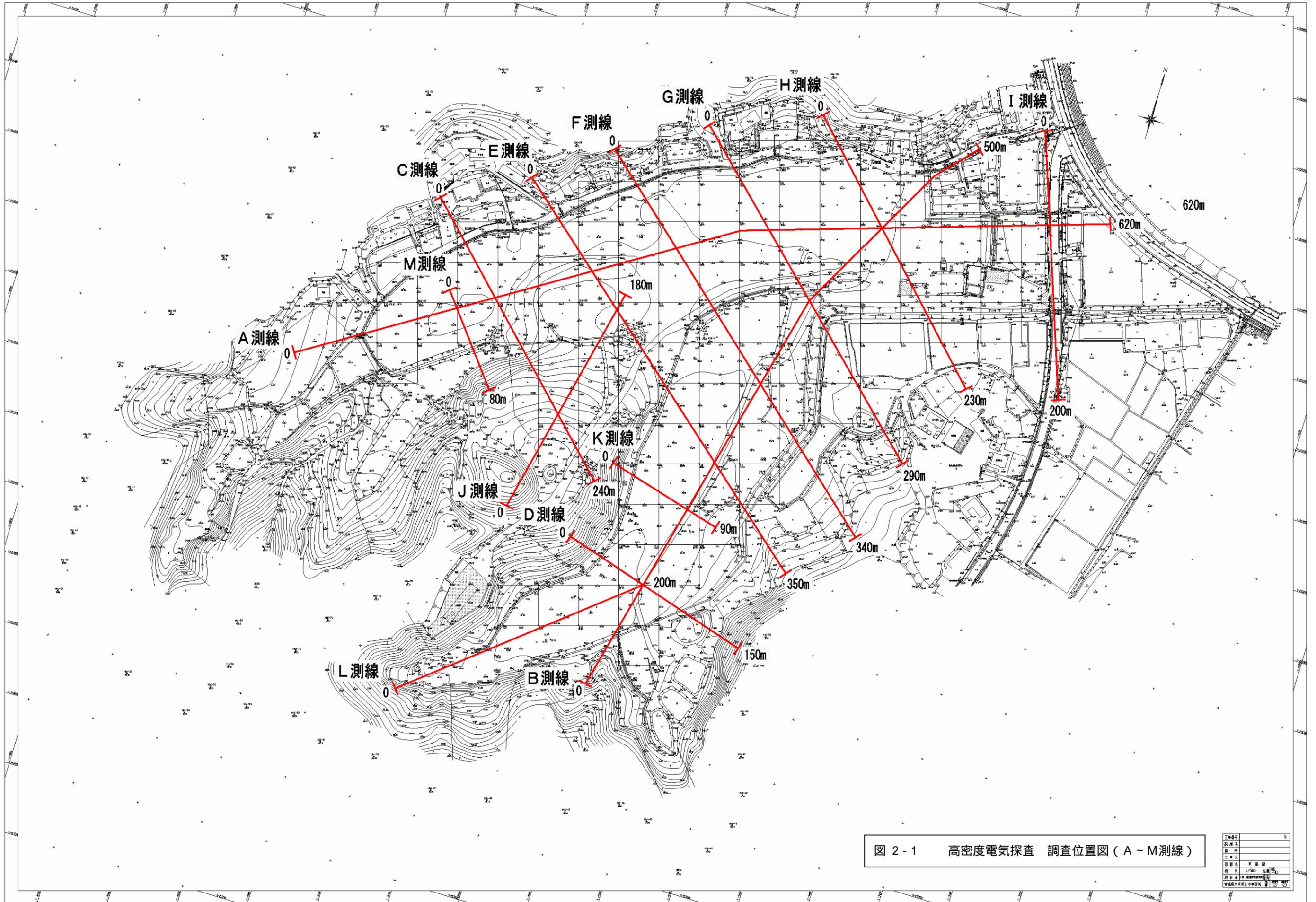
図 2 - 1 高密度電気探査 調査位置図 (A ~ M測線)
