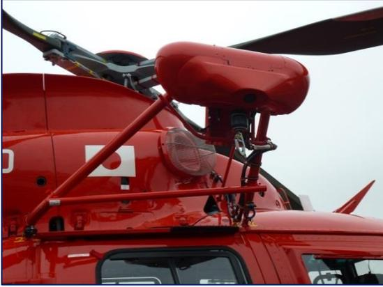
隊員を吊り下げ地上に降ろし，要救助者と隊員を吊り上げて機内に收容する装置です。
