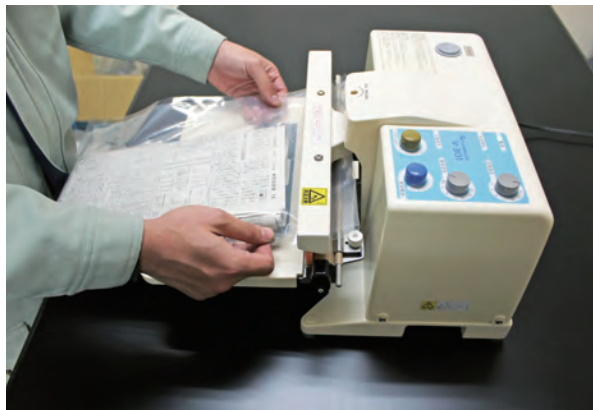
写真6-14 カビ防止シーリングパック作業
