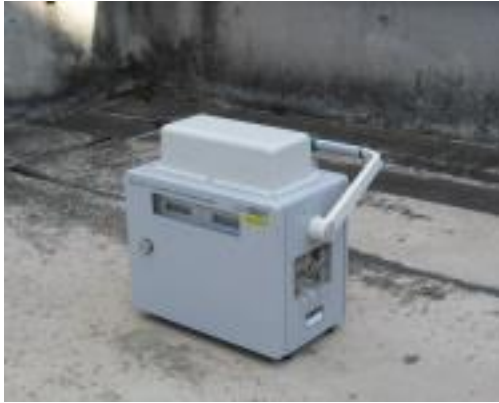
県庁屋上に設置した 可搬型モニタリングポスト
