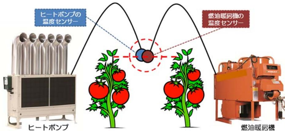
ハイブリッド方式運転時の温度センサーの設置
