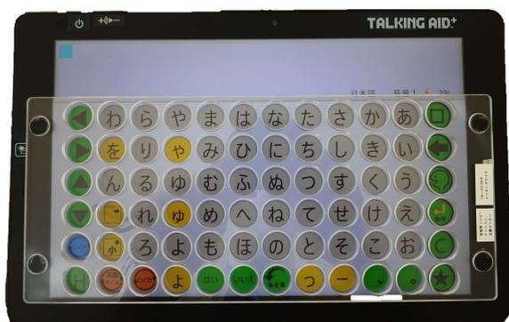
**特徴** タッチパネル上の文字で作成した文章を音声で読み上げて伝える。一部通信機能がある。持ち運びしやすい。
