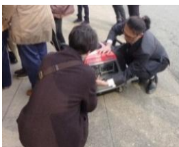
【ガソリンタイプの発電機】
