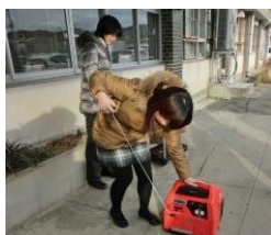
【カセットボンベタイプの発電機】
